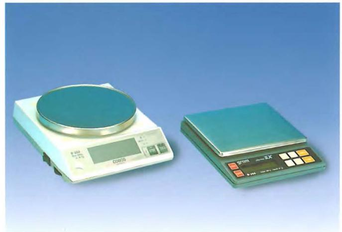
Balanças electrónicas para a dosificação precisa dos dois componentes do esmalte.
